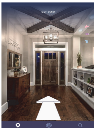
Рис.1. Скриншот мобильного front-end компонента системы EERouter дополненной реальности. Мобильный компонент работает на смартфоне iOS. Это показывает, как AR-содействие профорientации реализуется на мобильном телефоне. Теги AR по телефону указать пути выхода и оставшееся расстояние должны быть охвачены пользователем, чтобы добраться до выхода двери.
