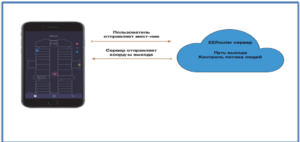
Рис.2. Облачная Архитектура EERouter. Местоположения на основе педометрии
