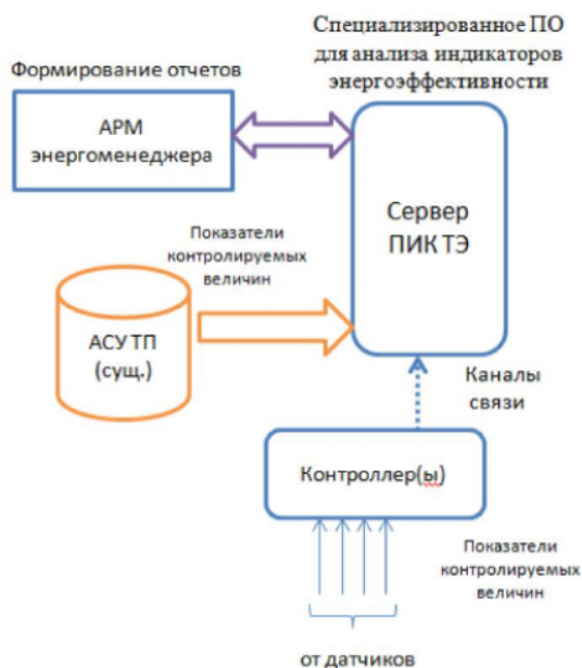
Рис. 4. Структурная схема программно-аппаратного измерительного комплекса энергоэффективности
